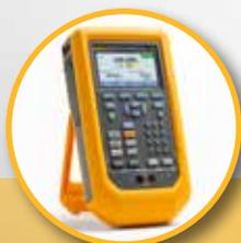
Con il nuovo calibratore di pressione automatico Fluke 729, la pompa elettrica automatica interna regola autonomamente la pressione durante i test, senza la necessità di regolazioni manuali.
