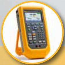
**729** 자동 압력 교정기를 사용해 압력 스위치를 테스트하면 스위치 설정 지점과 재설정 지점 그리고 불감대가 자동으로 감지 및 문서화되므로 작업 시간을 줄여주며 믿을 수 있고 반복 가능한 결과를 얻을 수 있습니다.
